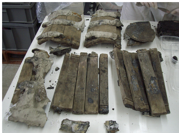
Figura 3. Portadora liofilitzada, comprovació de l'estat de la fusta
